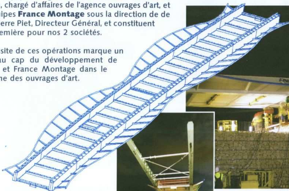
Passerelle en cours de lançage (avancement moyen de 20 mètres à l'heure)
